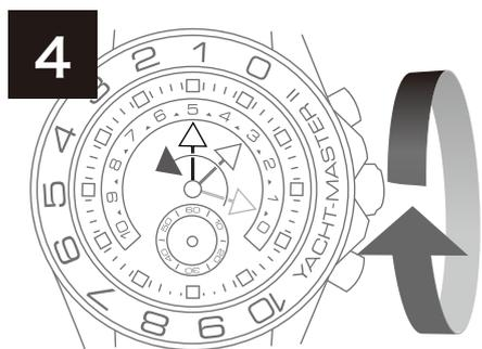
④ 竜頭を上方向（右回り）に回すと、カウントダウンの針が動き出しますので、カウントダウンを開始したい分数で針を止めます。
