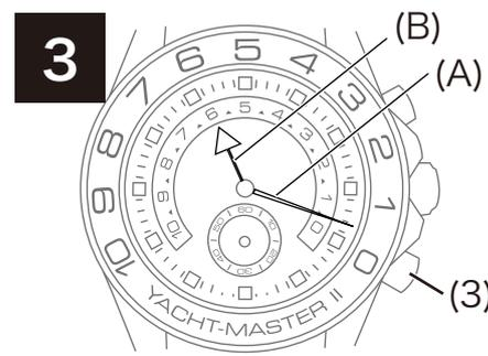
③ (3) のプッシュボタンは「フライバック機能」を備えており、カウントダウン中に押すと、瞬時に (3) のクロノグラフ針が 12h 位置に戻り、また (B) のカウントダウン針も瞬時にセットした時間に戻ります。
