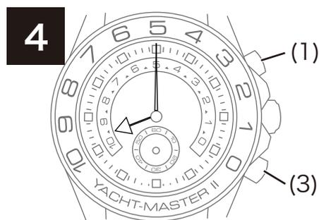
④ (1) のストップボタンでクロノグラフ針を止め、(3) のリセットボタンを押し、初期設定の状態に戻ります。
