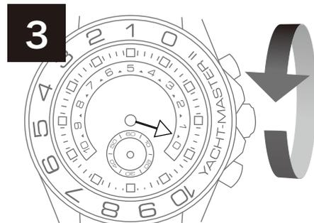
③ ねじ込み式竜頭を下方方向に回し、緩めます。
