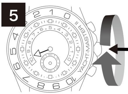
⑤ カウントダウンの分数でセットしたら、竜頭を押しこみながら ねじ込み式竜頭を閉じます。
